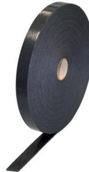
Top-Plast Trennwandband 610 ist ein einseitig selbstklebendes Band, das direkt von der Rolle verarbeitbar ist. Es zeichnet sich durch dauerhafte, hohe Elastizität aus. Trennwandband 610 ist stark klebend - auch bei niedrigen Temperaturen. Besonders geeignet ist es für Metallunterkonstruktionen und den Trennwandbau.
