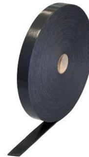
Top-Plast Trennwandband 640 ist ein einseitig selbstklebendes Band, das direkt von der Rolle verarbeitbar ist. Es zeichnet sich durch dauerhafte, hohe Elastizität aus. Trennwandband 640 ist stark klebend - auch bei niedrigen Temperaturen. Besonders geeignet ist es für Metallunterkonstruktionen und den Trennwandbau.
