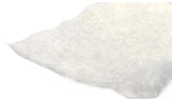
Top-Cell<sup>®</sup> isoGLAS<sup>®</sup> Nadelvliese sind aus Einzelfasern hergestellte flächige Textilien, die durch ein mechanisches Verfahren verfestigt wurden und durch ihr eigenes Haftvermögen zusammengehalten werden. Die Texturierung sorgt für ein grosses Speichervolumen und somit gute Isolationswerte.
