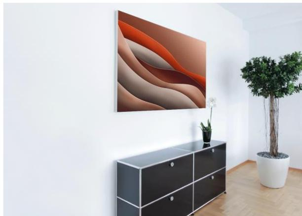
Top-Phon<sup>®</sup> Akustikbilder werden zum schalldämmenden Blickfang in Ihrer Raumgestaltung. Sie bestehen aus einer Absorberfüllung in einem Spannrahmenprofil aus Aluminium mit Stoffbespannung. Der umlaufende Aluminiumrahmen hat eine Bautiefe von 40 mm und vorne eine Aufnahmenut für die Stoffbespannung.
