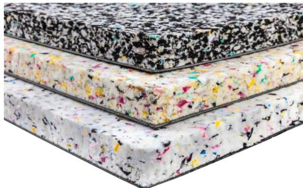
Verbundschaumstoff ist ein Recyclingprodukt, der aus zerkleinerten PU-Schaumstoffresten hergestellt wird. Unter Beigabe elastischer Bindemittel werden die Schneidabfälle der Schaumstoffindustrie zu einem homogenen Werkstoff verpresst. Die Schaumstoffelemente können in Grösse und Materialbeschaffenheit variieren, ebenso die Additive. Die Verbundschaumstoffe sind eine wirtschaftliche Alternative zu Primär-PUR-Schaumstoffen mit höheren Raumgewichten.
